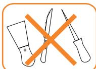
Si desea retirar la escarcha de las paredes no utilice elementos cortantes o punzantes porque puede dañar la superficie de la unidad y su terminación.
